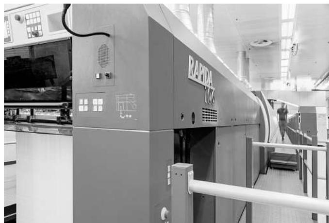
Bei der Maschinenlänge kommen einige Meter zusammen, die die Drucker pro Schicht zwischen Anleger und Auslage laufen. Im Hintergrund ist auch das Kaltfolienmodul erkennbar.
