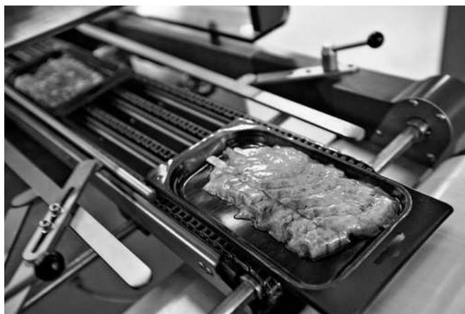
Formstabil und glänzend verpackt: VST-Folie von Cryovac und die eigens für Micarna entwickelte Schale von Bachmann, mit Sealpac-Technik perfekt aufeinander abgestimmt. (Foto: Bachmann Forming, Sealed Air Corporation, SEALPAC Schweiz GmbH)
