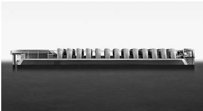
Selbst die Integration von Inkjet-Systemen in die Druckmaschine ist inzwischen Realität. Die Inkjet-Einrichtung in der Speedmaster XL 106 ermöglicht im Zusammenspiel mit Prinect Inspection Control die Prüfung von Einzelnutzen und das Markieren von fehlerhaften Nutzen. Diese markierten Nutzen können in der Weiterverarbeitung z. B. in der Faltschachtelklebemaschine automatisch erkannt und ausgeschleust werden. Selbstverständlich ist auch das Ein-drucken von alphanumerischen Codes möglich.
