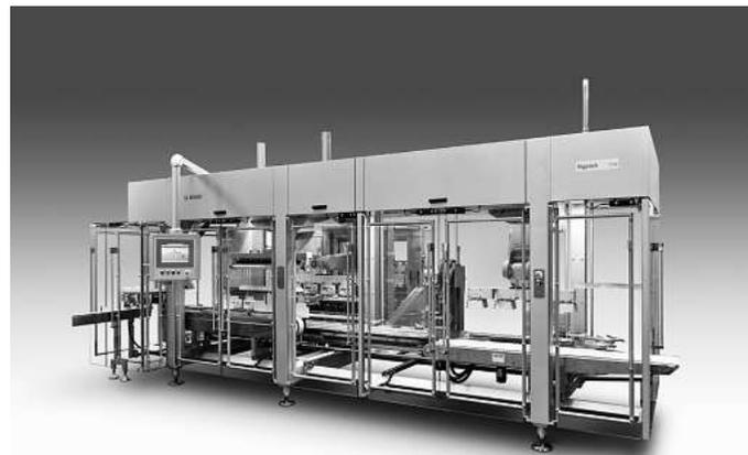
Das verbindende Element der Anlage ist ein neu entwickelter Schachteltransport, der die Anlagenauslegung hochflexibel macht und über einen grossen Formatbereich wechselliefelfrei umstellbar ist. Jeder Karton wird auf einem einfachen und leichten Wagen sicher und präzise durch die Anlage transportiert, dabei sind die Abstände der einzelnen Wagen zueinander frei veränderlich. Dadurch kann die Batchgrösse auf Knopfdruck geändert werden, beispielsweise von vierbahnigem auf zweibahnigen Betrieb.
