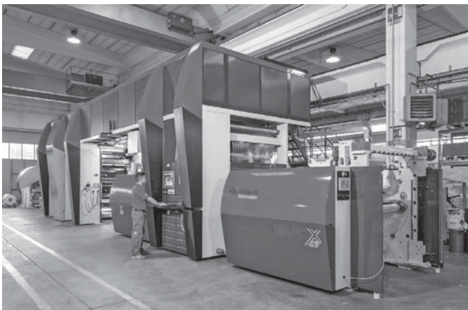
Die EVO XG-Baureihe ist für grössere Druckbreiten bis zu 2 m und hohe Druckgeschwindigkeiten bis 600 m/min. ausgelegt.
