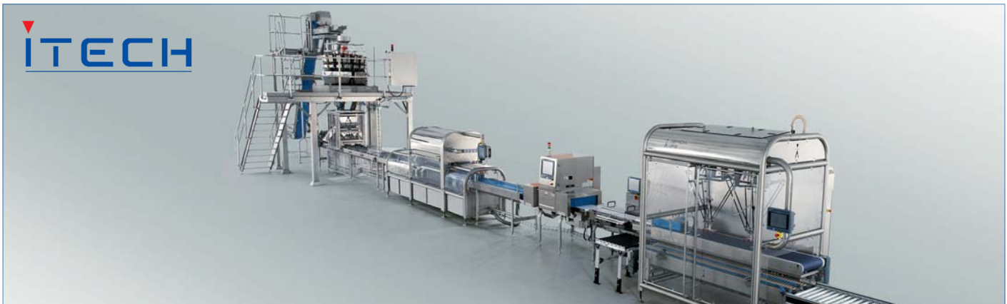
Die kompakte Verpackungslösung für die Hundekekse mit der Mehrkopfwage CCW-SE von Ishida.
