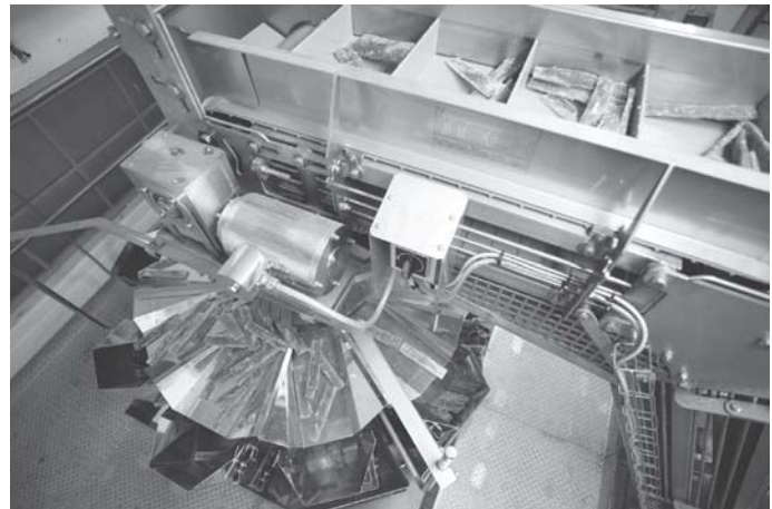
Von oben gelangen die Kautsticks auf die Mehrkopfwaage. Mit ihren grossen 5-Liter-Volumen-Schalen verarbeitet die Mehrkopfwaage problemlos die bis zu 18,5 cm langen Kautsticks.
