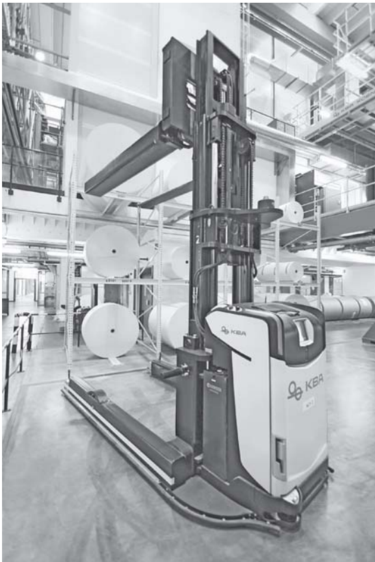
AGV bei der Auslagerung von Papierrollen aus dem Tageslager.
