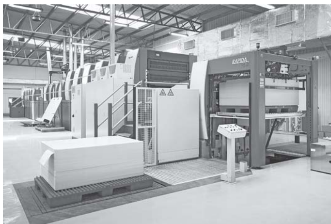
Schon vielerorts Realität: Automatisierte Stapellogistik am Anleger einer Rapida 162.
