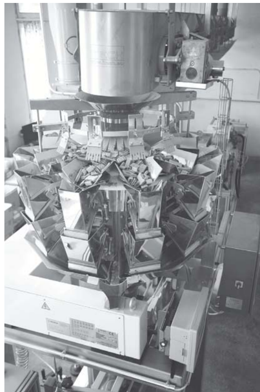
Die kompakte Verpackungslösung für die Hundekexse mit der Mehrkopfwaaage CCW-SE von Ishida.
