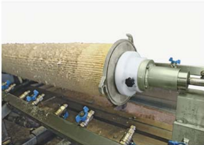
Die Abreinigung erfolgt mittels präzisen Wasserstrahlen, welche den Staubkuchen vom Filtermedium lösen.
