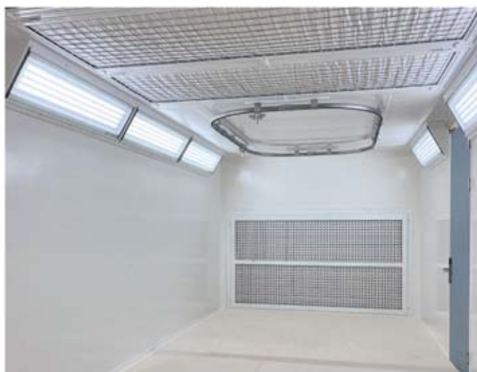
Kombinierte Farbspritz- und Trocknungskabine mit LED-Beleuchtung.
