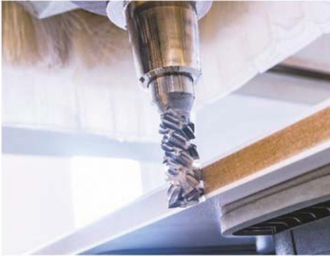
Der Diamaster PRO3 – die erste Wahl beim Formatieren auf Nestingmaschinen und Losgrösse-1-Anlagen. (Foto: Leitz)
