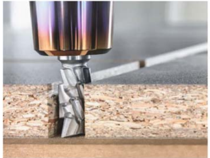
Schwer zu bearbeitende Materialien und heikle Dekore oder Oberflächen sind das Spezialgebiet der Diamaster EdgeExpert-Schafffräser von Leitz. (Foto: Leitz)
