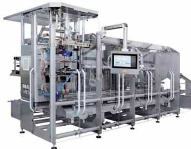
*Blockpackmaschine SBS für staubarmes Verpacken von pulverigen Produkten.*
