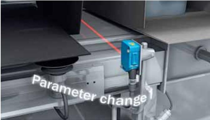
*Intelligente Maschinen: Bei der Integration und Erstinbetriebnahme der Sensoren können Sensor-Parameter-Sets auftrags- oder formatspezifisch hinterlegt und im Betrieb geladen werden.*
