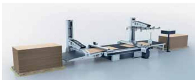
Erhältlich in unterschiedlichen Maschinenkonfigurationen vereint das BHS150 vollautomatisiertes Materialhandling mit leistungsstarkem, unterbrechungsfreiem digitalem Zuschnitt: Die Produktionslinie besteht aus einer Beladeeinheit, einem G3 oder D3 Cutter sowie einer Entladeeinheit, welche mit einer maximalen Stapelhöhe von 1,5 m deutlich längere und unterbrechungsfreie Betriebszeiten bietet. Damit lassen sich auch Grossauflagen wirtschaftlich und effizient endverarbeiten.
