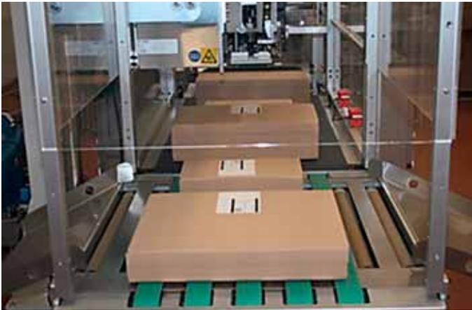
CMC CartonWrap: Maschinenausgang mit Adressierung der versandfertigen, stets unterschiedlich grossen Versandkartons.
