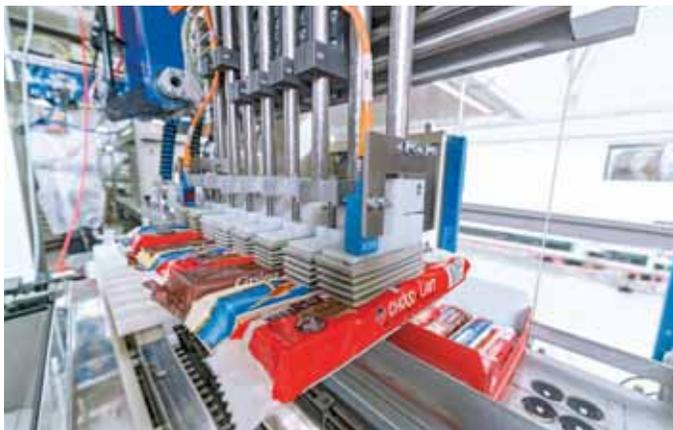
*Nach dem Upgrade verpackt der Riegelpacker wieder 380 Produkte pro Minute in Schachteln.*
