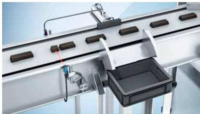
*Bewährte Sensortechnologien mit Best-in-Class-Detektionsvermögen erkennen automatisch Lücken im Materialstrom dank in die Sensoren integrierter Logikfunktionen zur Signalverarbeitung.*
