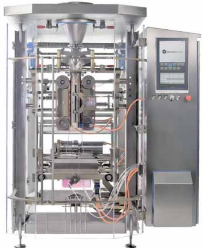
AGILIS: vertikale Form-, Füll- und Verschlussmaschine.
