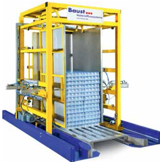
Die Ware wird von der Quellpalette auf die ca. 1 bis 2 cm tiefere Zielpalette übergeschoben. Die Ware wird durch eine Rück- und zwei Seitenwände gegen das Umkippen gesichert. Schiebebleche sorgen für eine optimale Funktionssicherheit und entsprechenden Schutz der Ladung. Die Anlagen sind für alle Paletten-Werkstoffe und -Typen einsetzbar. Eine moderne Versuchsanlage steht für Tests im Werk zur Verfügung. Weitere Auskunft erhalten Sie bei:
